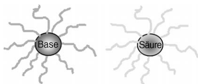
Abbildung 2. Isolierte Säure- und Basengruppen im Kern sternförmiger Polymere. [10] Basische Gruppe: -\text{CH}_2\text{N}(\text{CH}_3)\text{py} (py = 4-Pyridyl). Saure Gruppe: -\text{C}_6\text{H}_4\text{SO}_3\text{H} .
